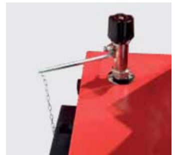
REGULADOR TERMO ESTÁTICO QUE ACTÚA SOBRE LA TOMA DE AIRE POSTERIOR PARA REGULAR LA TEMPERATURA DE LA CALDERA.
